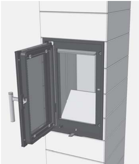
Fig. 4.12 Dépose de la brique de sole de la chambre de combustion
