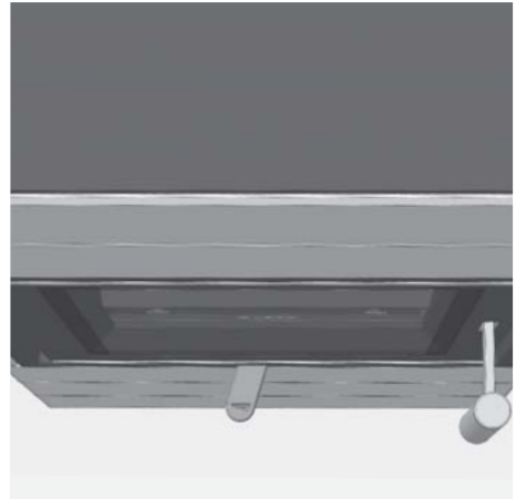
Fig. 4.7 Levier d'air de combustion complètement à gauche, air de combustion fermé
