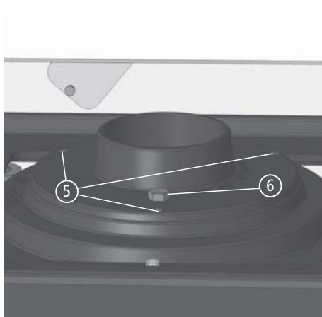
Fig. 3.23 Monter la partie supérieure de la console pivotante
