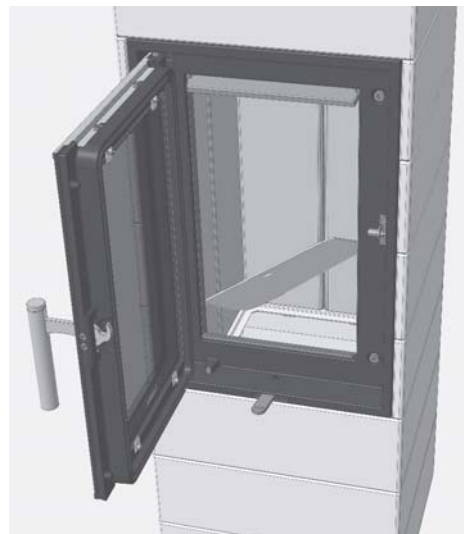
Fig. 4.13 Dépose de la plaque de fond de la chambre de combustion
