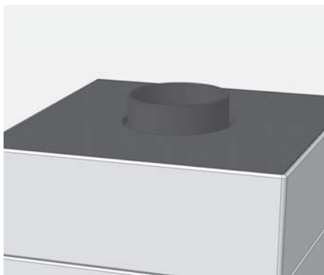
Fig. 3.14 Remplacer la tubulure des gaz d'échappement supérieure par le biais de la tubulure des gaz d'échappement pivotante
