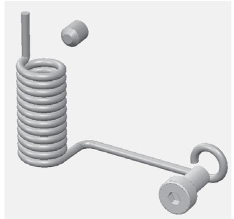
Fig. 3.5 Ressort de porte, vis sans tête et vis de serrage
